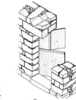
Schema a trilitte omogeneo con triangolo di scarico: stipiti e architrave in conci lapidei
